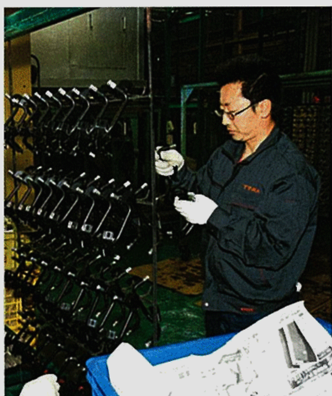
カチオン電着塗装を施した後、マスキングのゴムキャップをはずし、目視検査をして、梱包する
