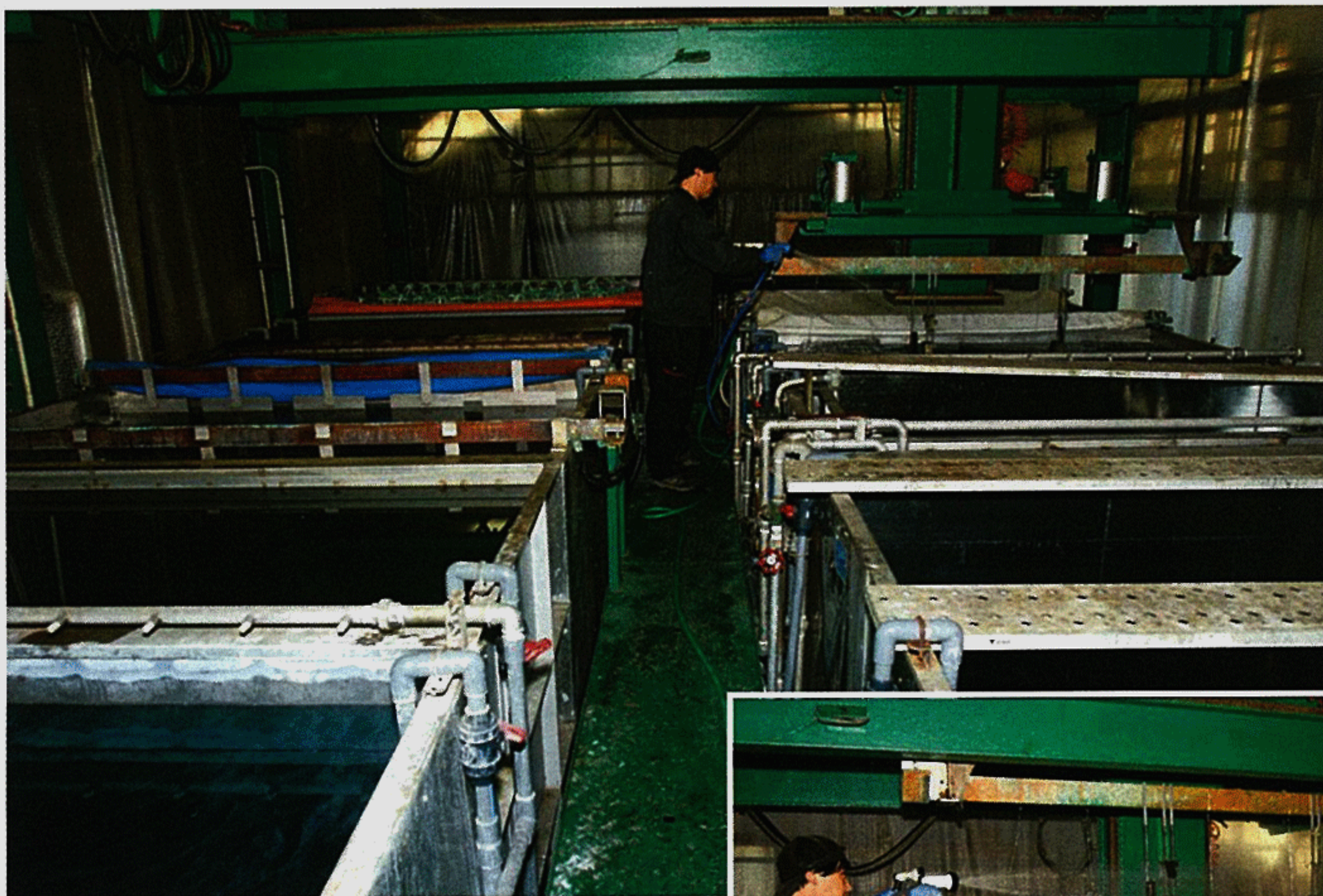
レゾナコートラインの無電解ニッケルメッキの作業場。薬品が入るタンクは5,000リットルと大きく、全部で16もあり壮観だ。温度は88度。随時水で冷却し表面にムラができないようにする
