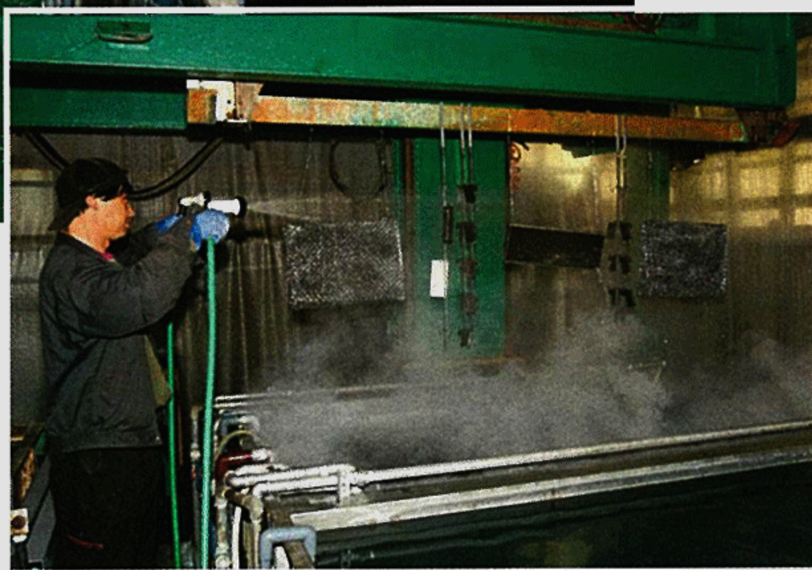
レゾナコートラインの無電解ニッケルメッキの作業場。薬品が入るタンクは5,000リットルと大きく、全部で16もあり壮観だ。温度は88度。随時水で冷却し表面にムラができないようにする
