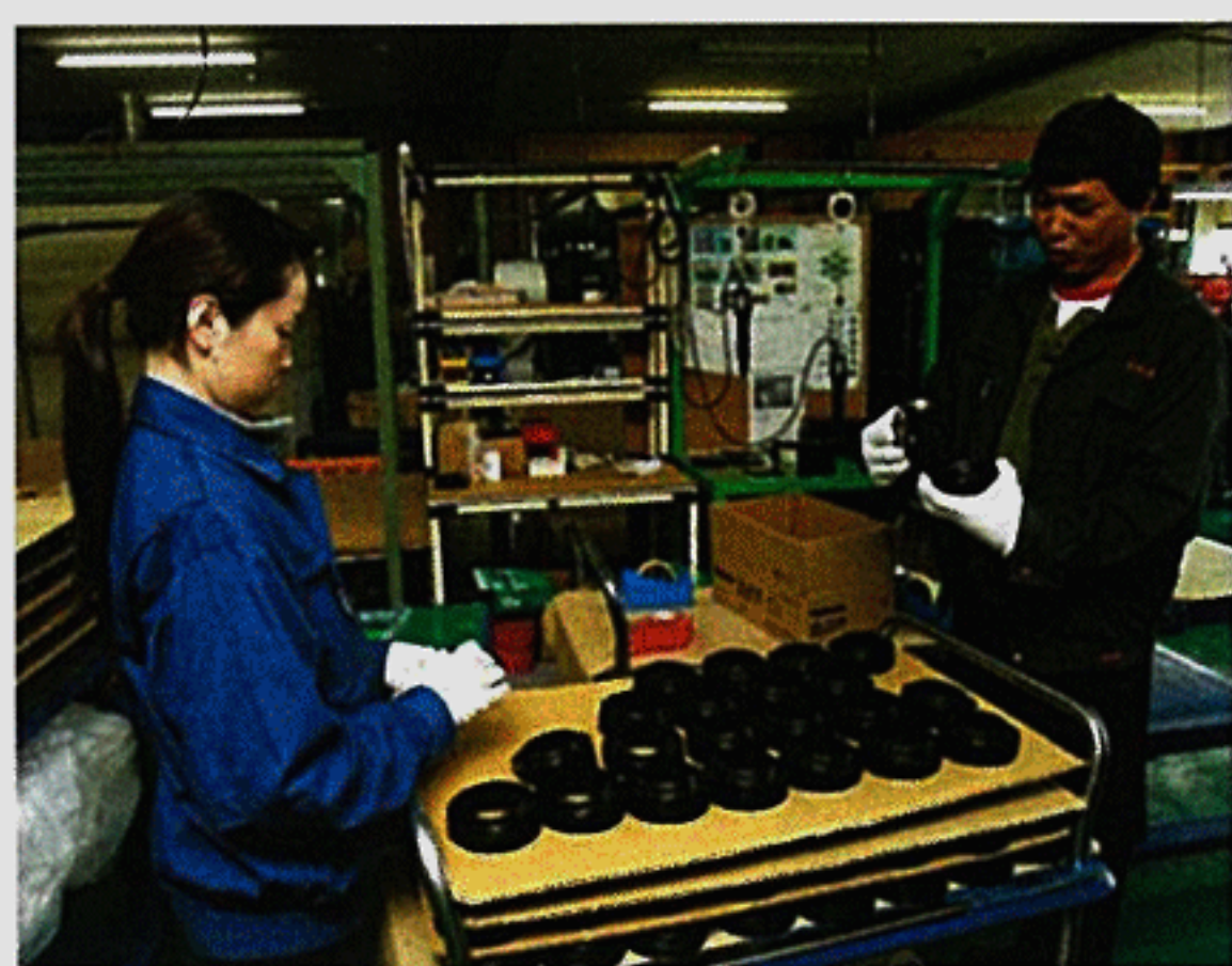
大手電気メーカーから受注した配電盤のボックスのカバー（カチオン電着塗装済）をビス留めする
