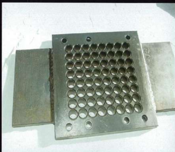
レゾナコート施工したゴム成型用金型
